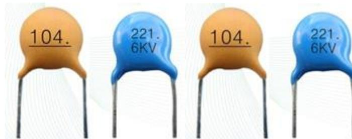
Así, 104 significa  $10 \times 1000 \times 1 \text{ p}[F] = 10 \text{ n}[F]$ , y en el ejemplo de la figura de la derecha, 221 significa  $22 \times 10 \times 1 \text{ p}[F] = 220 \text{ p}[F]$ .
