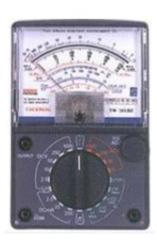
Para recibir una tolerancia constante de medición, el multímetro trabaja en diferentes rangos. Algunos multímetros cambian los rangos automáticamente y otros dependen de que el usuario lo haga.
