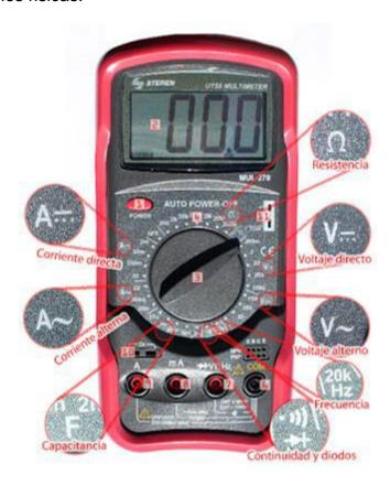
El multímetro integra una variedad de instrumentos por ejemplo para realizar mediciones de tensión eléctrica se utiliza voltímetro, la corriente con un amperímetro y la resistencia con un ohmímetro u óhmetro y existen multímetros análogos y digitales.
