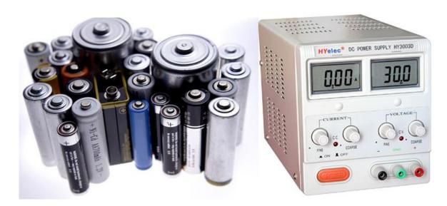
Para el *módulo de circuitos eléctricos 1* se va a utilizar fuente de Corriente Continua (CC). Una fuente de corriente continua produce una tensión que se mantiene constante en magnitud con el tiempo (esto en sentido ideal, pues una pila o una batería conforme transcurre el tiempo de uso va disminuyendo su carga).
