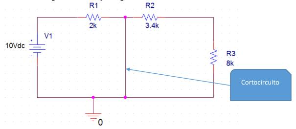
La corriente tiende a infinito cuando la resistencia tiende a 0 debido a que la única resistencia que se presenta para el circuito en este caso es la correspondiente a los conductores, sin embargo, la batería solo puede entregar una cierta cantidad de corriente por lo que la corriente será entonces la máxima que pueda entregar.
