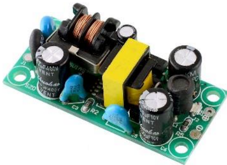
Fuente: ( electronics.stackexchange.com , 2016), Figura 21. Fuente conmutada DC de 5V
