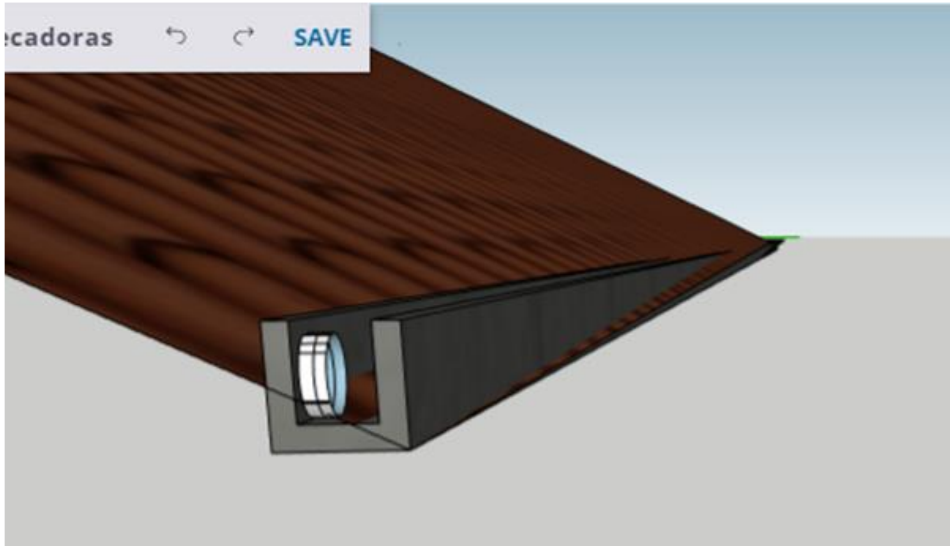
Figura 11. Vista riel para techo corredizo. Fuente : del autor.
