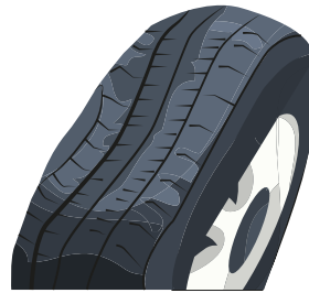
Figura 2: llanta deformada por flatspotting Fuente, https://images.app.goo.gl/u4Retr-2BaMg7bT477
