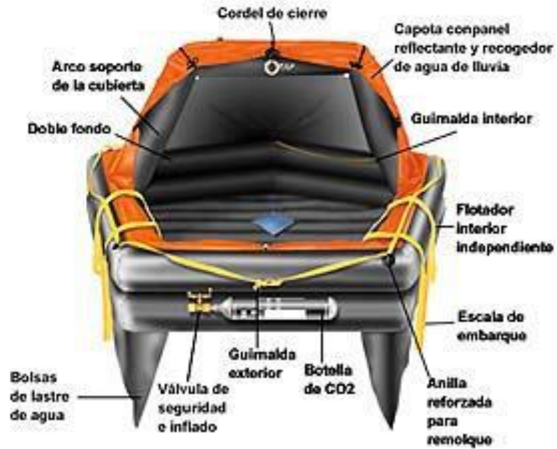
Diagrama de una balsa salvavidas inflada
