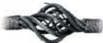
**S**e crea una “jaula” por la liberación repentina de la tensión y el rebote resultante del cable. Estos torones y alambres no retornarán a sus posiciones iniciales. El cable se debe reemplazar inmediatamente.
