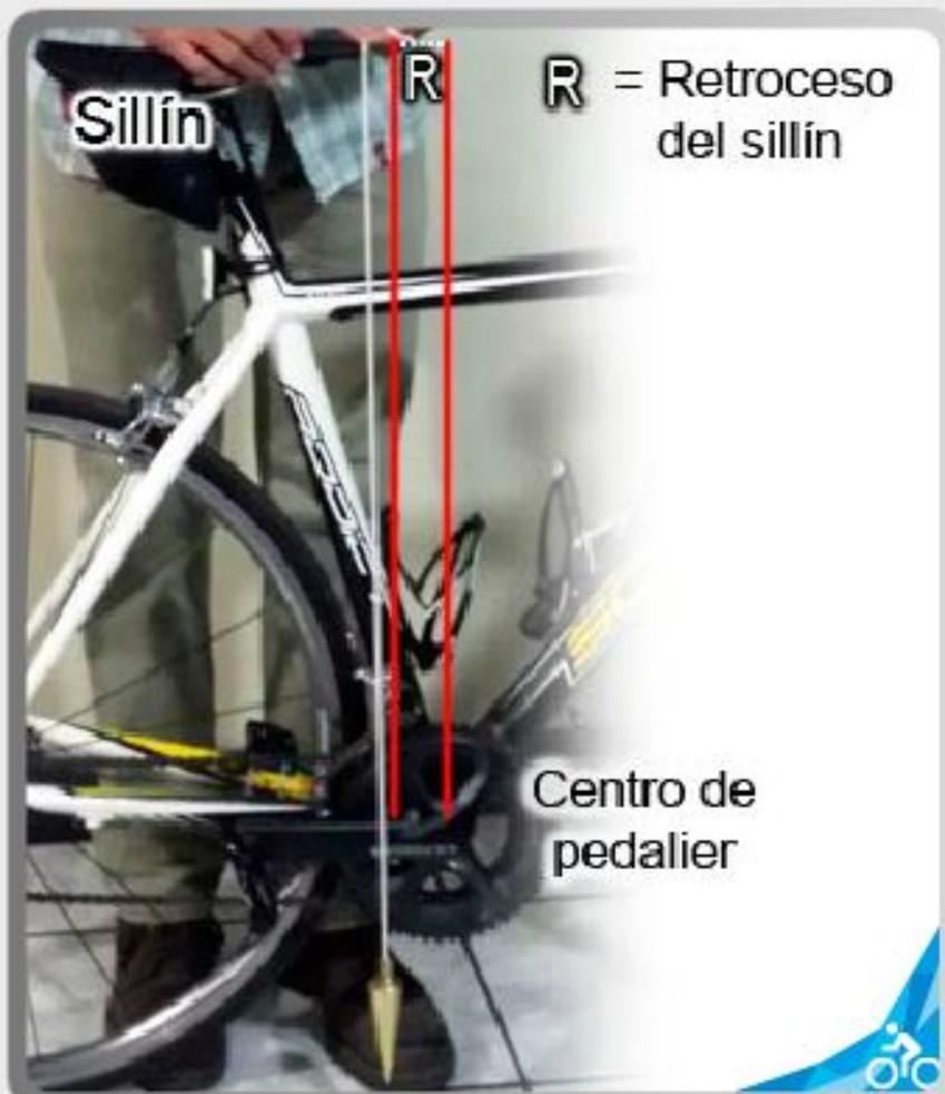
Para medir el retroceso del sillín tiraremos una plomada desde la punta del mismo hasta la caja de pedalier, y comprobaremos la distancia que hay entre el cordel y el centro del pedalier.
