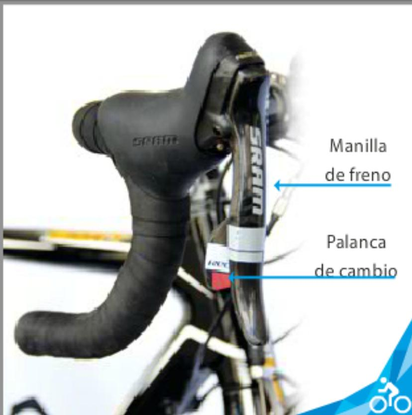
Las manillas de los sistemas de ruta alojan en el mismo mecanismo el freno y la palanca para el cambio.
