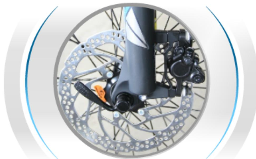
Los hidráulicos son utilizados en bicicletas de montaña y ruta. En este tipo tenemos de casco y de disco.
